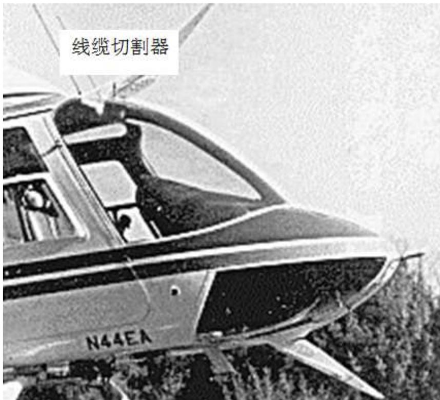
图1 安装在一架贝尔 206 型直升机上的撞线防护系统
